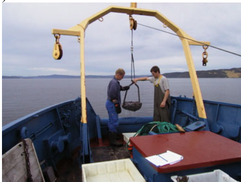
Figur 1. a) Provtagning med van Veen grabb och b) siktning och fixering av proven.
